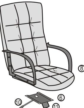
6. Сиденье установите отверстием в металлической площадке на газпатрон.
