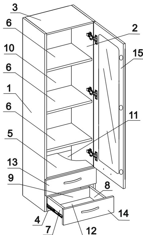
Перед началом сборки необходимо разъединить полновыкатные направляющие. Для этого максимально раздвинуть направляющую и нажать на пластиковый фиксатор. Далее выдвинуть внутреннюю часть из внешней.
