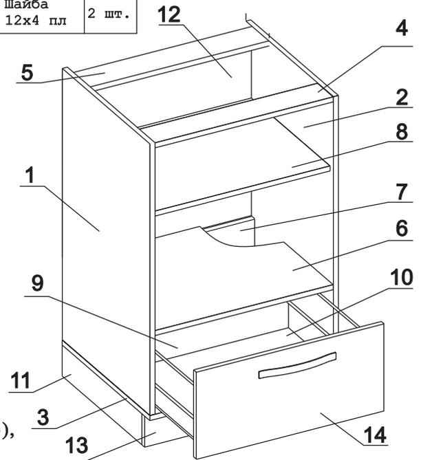
**Внимание!** Для установки цоколя (№11) на левую или правую сторону, развернуть скобу зеркально, относительно скобы, установленной на цоколе (№13)
