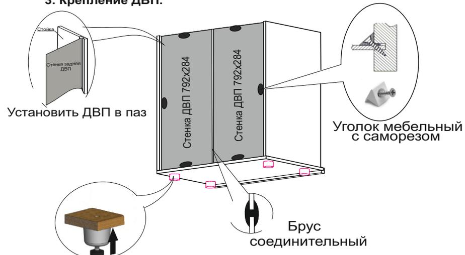
Регулировка высоты осуществляется через сквозное отверстие в дне конструкции, отверстие для регулировки закрывается декоративной
